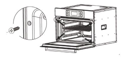
先將本產品抬起,嵌入已預留位置的櫥櫃內〔注意電源插頭的擺放位置,以便完成安裝後接上電源〕。打開爐門,利用隨機附送的4粒螺絲,按上圖的箭咀位置將產品牢固安裝於櫥櫃上。確保產品已穩固安裝,才接通電源進行測試。
